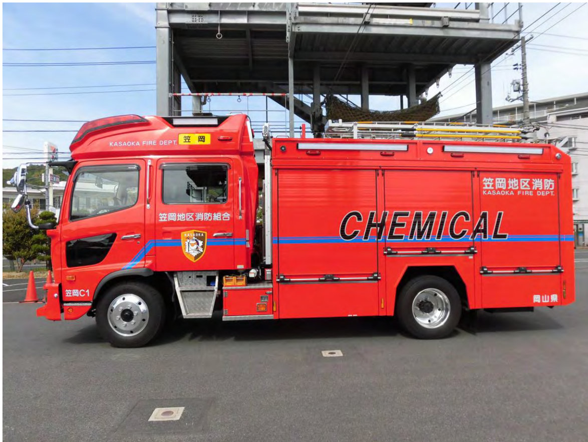
消防車両の整備更新（化学消防ポンプ自動車）
